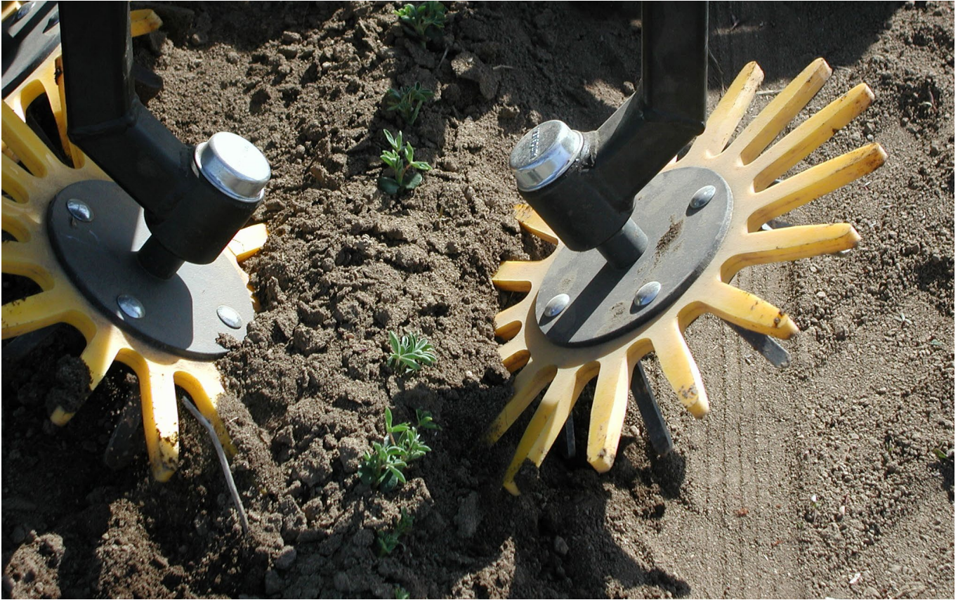
Die Fingerhacke ermöglicht die Unkrautbekämpfung innerhalb der Pflanzenreihen
