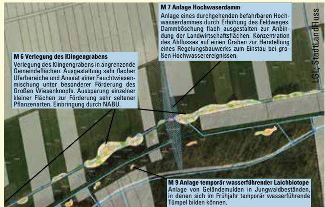
Beispiel Klingengraben (Bau: Dezember 2015 bis März 2017): Der Oberflächenwasserabfluss wird durch Abflachungen und geschwungenem Grabenlauf verzögert, ein querender Feldweg wurde geringfügig angehoben und mit einem Durchlass versehen, die Restflächen bleiben landwirtschaftlich nutzbar.
