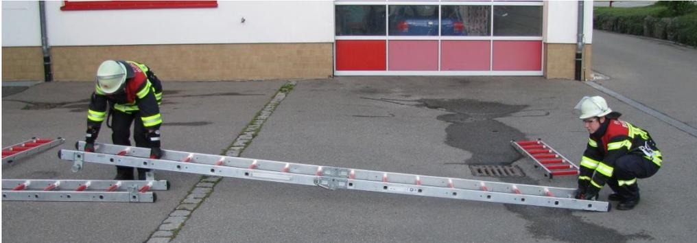
Die Oberleiter, deren Federsperrbolzen nach unten zeigen, wird über der Unterleiter abgelegt.
