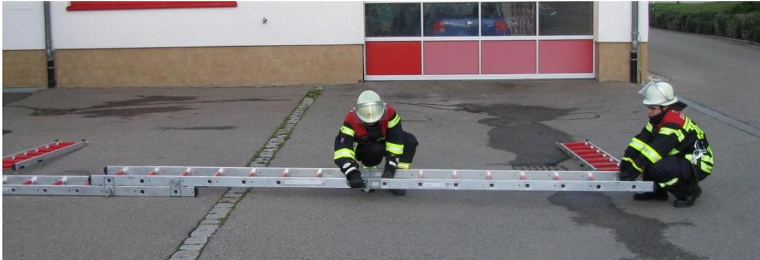
Ein Feuerwehrangehöriger arretiert die Federsperrbolzen, der zweite Feuerwehrangehörige unterstützt am Leiterkopf durch Anheben der Oberleiter. Anschließend werden die Scharnierverschlüsse der Oberleiter arretiert.
