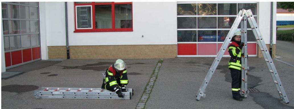
Das stehende Leiterpaket wird zu einer Stehleiter (Bock) entfaltet, anschließend wird das innen eingesteckte Aufsteckteil entnommen. Die Scharnierverschlüsse und Sperrbolzen des liegenden Leiterpaketes werden geöffnet und in geöffnetem Zustand gelassen.
