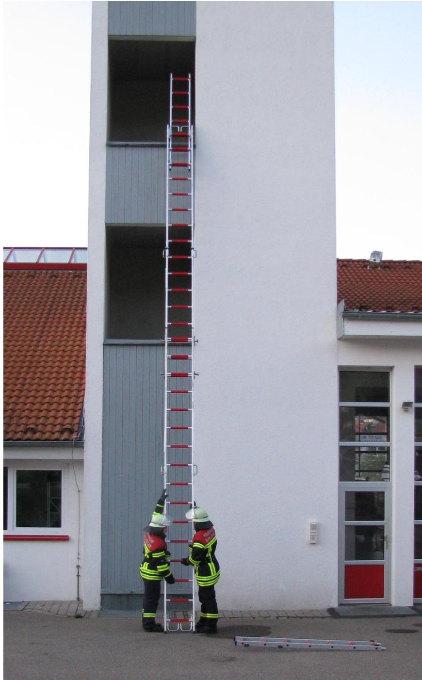
Der Leiterfuß wird vom Einsatzobjekt abgerückt, so dass ein Anstellwinkel von  $65^\circ$  bis  $75^\circ$  erreicht wird.
