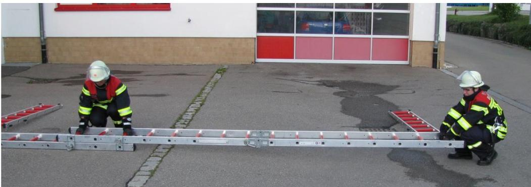
Die beiden Leiterteilpaare werden mit den Federsperrbolzen verbunden. Hierbei kann die erforderliche Rettungshöhe variiert werden, je nachdem wie viele Sprossen beim Verbinden der Leiterteilpaare überlappt werden. Mindestens drei Sprossen müssen überlappen. (Die Leiter ist so ausgelegt, dass ein Überlappen von weniger als drei Sprossen nicht möglich ist.)
