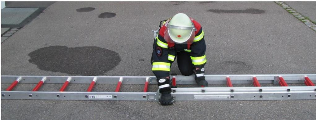
Die Scharnierverschlüsse der Unterleiter werden im liegenden Zustand
