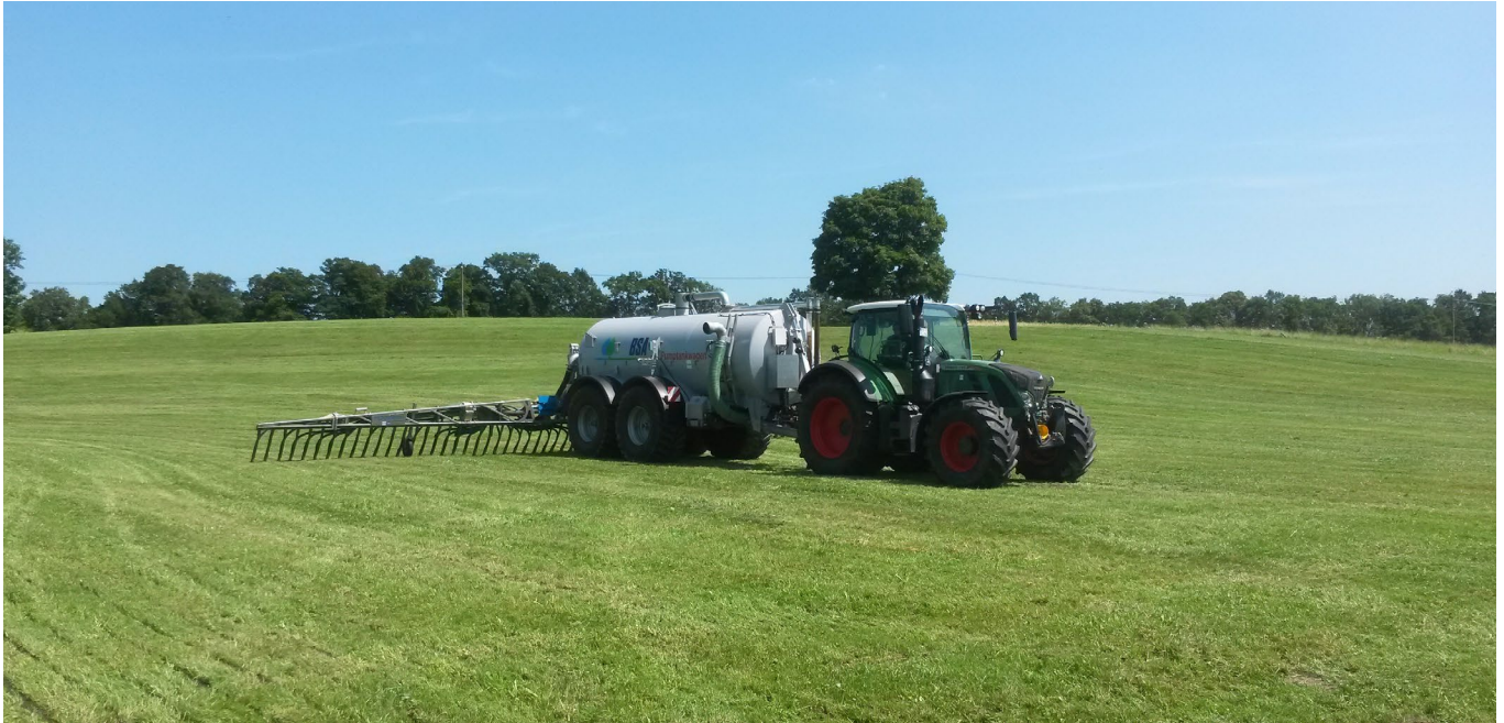
Foto 1: Schleppschuhverteiler ermöglichen bodennahe Gülleausbringung.
